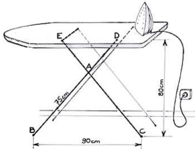
Les tiges  $[EC]$  et  $[BD]$  de même longueur constante sont articulées en  $A$ . La longueur  $AB$  est égale à  $75\text{ cm}$ . Sous la table, le point  $D$  est fixe et le point  $E$  peut être déplacé pour ajuster la hauteur. On sait que lorsque  $BC$  est égale à  $90\text{ cm}$ , la table a une hauteur de  $80\text{ cm}$  et est parallèle au sol pour cet écartement.
